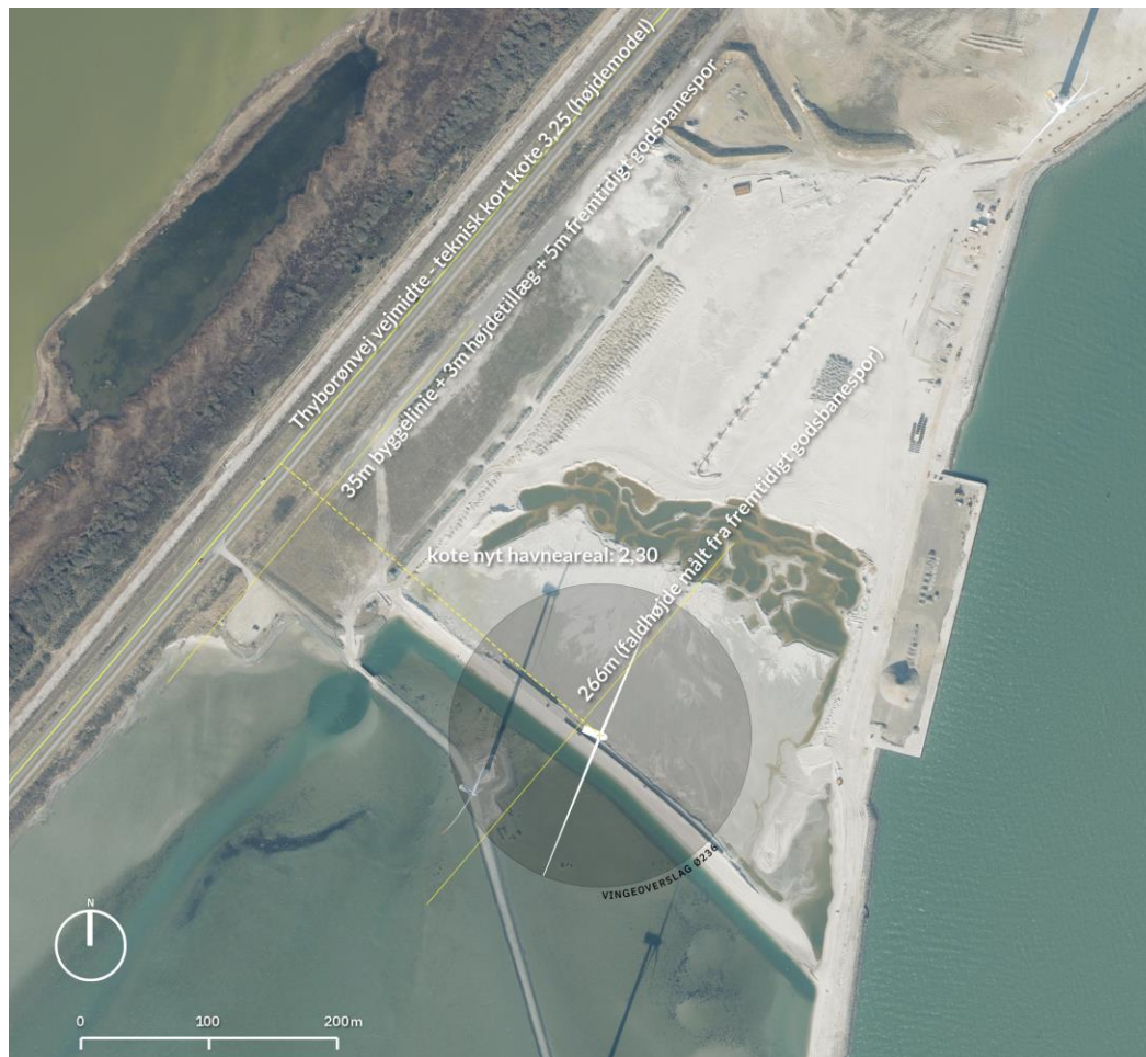
Figur 4.3: Den nye vindmøllens placering ved Sydhavnsvej er fastlagt så der sikres en afstand til Thyborønvej på minimum 326 meter, målt fra vindmøllens tårn til vejmidten på Thyborønvej. Dermed er vindmøllen placeret med mere en afstand af mindst 1 x vindmøllens totalhøjde målt fra statsvejens vej- byggeelinie inkl. højde- og passagetillæg. I afsnit 4.5 er der redegjort for at skyggekast og is-afkast fra vindmølle, ikke vil påvirke trafikikkerheden på Thyborønvej.
