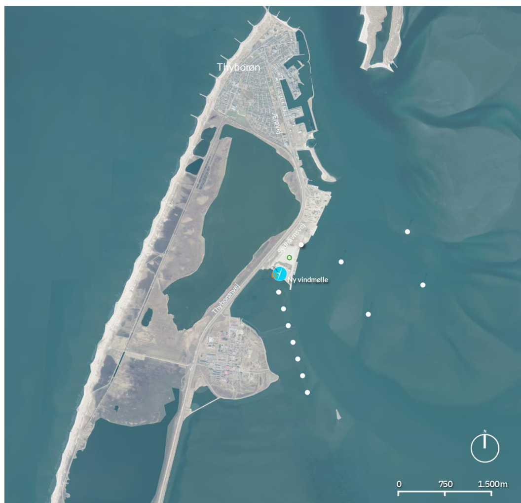
Figur 4.1: Den nye vindmølles placering ved Sydhavnsvej er vist med lys blå markering. Møllen placeres på den sydligste del af Thyborøn Sydhavn, ca. 2 km syd for Thyborøn og vil få en totalhøjde på 266 meter. Den grønne cirkel markerer placeringen af den mølle på 217 meter, der tidligere er godkendt på Thyborøn Sydhavn i forbindelse med Lokalplan 233. De nærmeste eksisterende vindmøller er vist med hvid markering. Det drejer sig om den eksisterende 198 meter høje vindmølle på Thyborøn Sydhavn, de otte ca. 120 meter høje vindmøller ved Rønland samt de fire vindmøller med en totalhøjde på 174,3 meter i Nissum Bredning. Den orange markering viser, at der vil blive nedtaget en Rønland vindmølle i forbindelse med realiseringen af den nye vindmølle.
