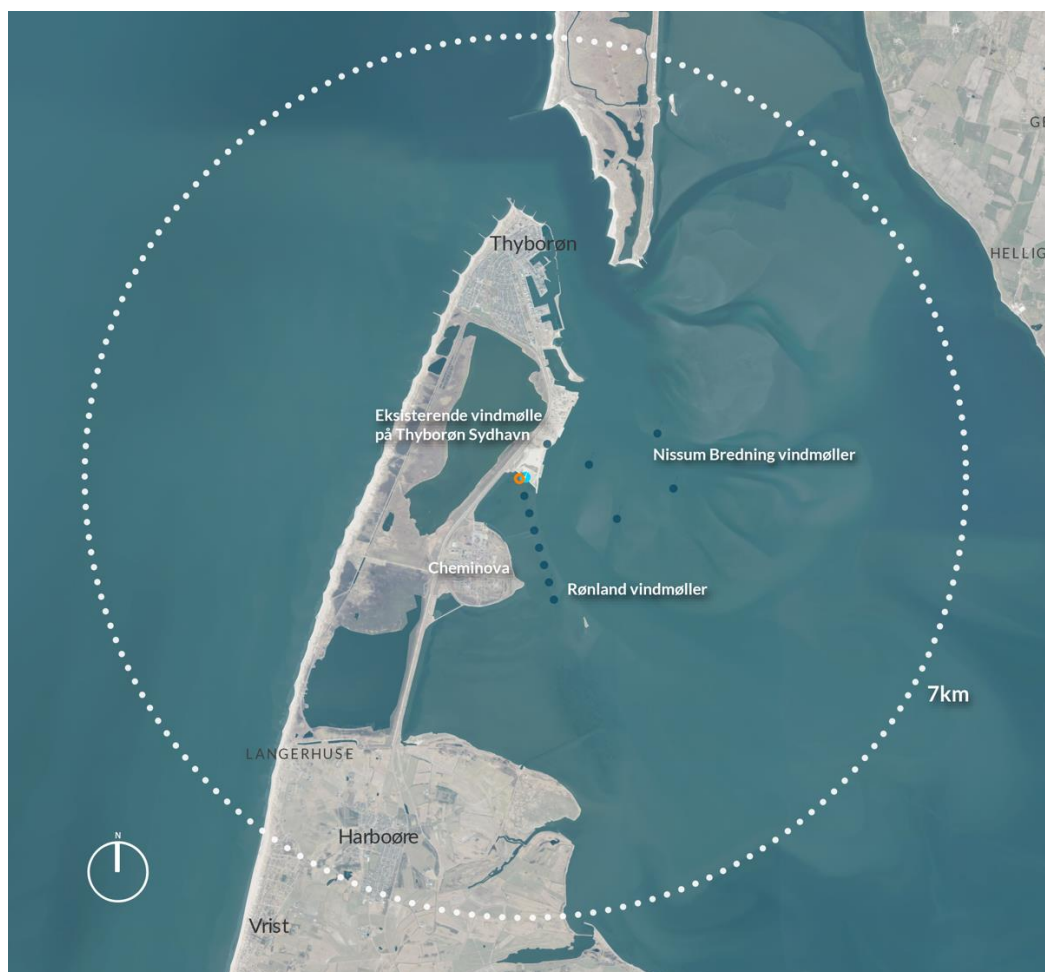
Figur 6.3: Projektområdet og de omkringliggende eksisterende vindmøller vist med blå-grå markeringer. I forbindelse med realisering er vindmølleprojektet nedtages en eksisterende Rønland vindmølle, denne vindmølle er markeret på kortet en orange cirkel.
